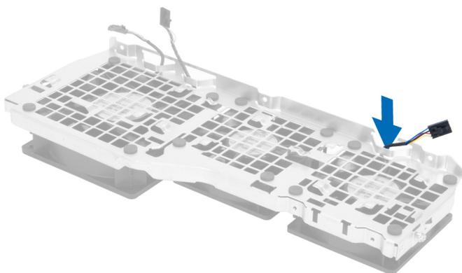
13. Retirez les languettes en caoutchouc de fixation du ventilateur du système. Soulevez le ventilateur et retirez-le de l'ensemble ventilateur.
