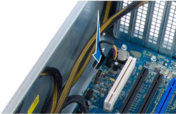
5. Retirez les vis de fixation du ventilateur du disque dur à la partie avant du châssis, puis le ventilateur de l'ordinateur.
