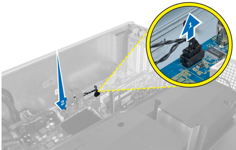
4. Retirez le câble du capteur de ses clips de fixation sur le châssis.
