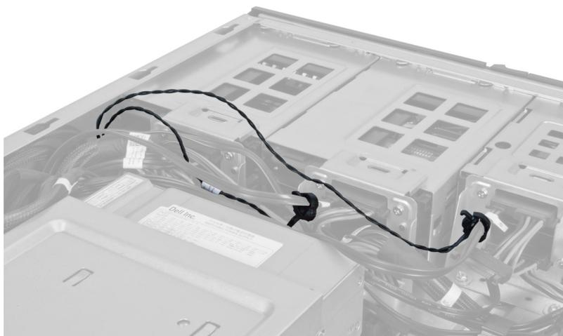
5. Ouvrez le loquet de fixation du capteur thermique et retirez-le de l'ordinateur.
