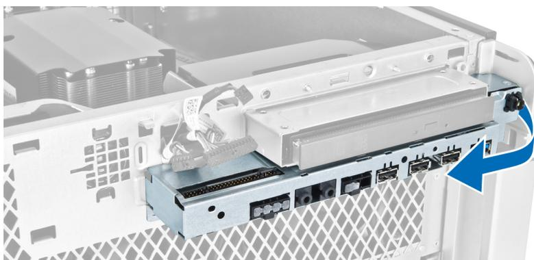
6. Faites glisser le bord opposé du panneau E/S avant vers l'extérieur pour dégager le module E/S du châssis.
