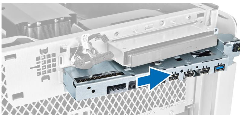
7. Retirez les vis de fixation du module USB 3.0 au panneau E/S et enlevez-le de l'ordinateur.
