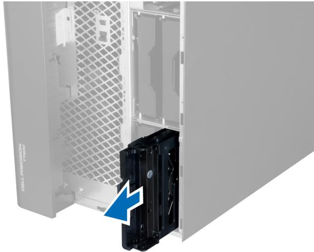
5. Si un second disque dur est installé, poussez le fermoir du support du second disque dur.
