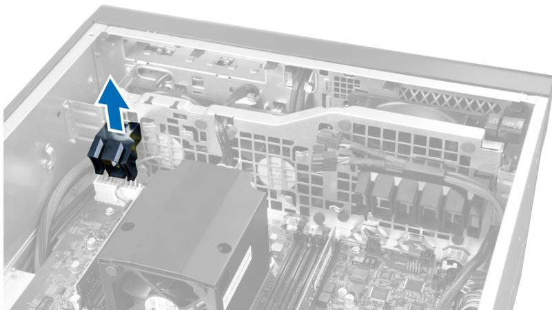
6. Faites glisser le second conduit d'air dans la direction du ventilateur du système pour le libérer des fermoirs.
